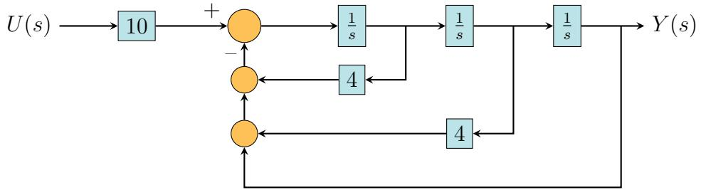
Tout d'abord on réduit la boucle de rétroaction la plus imbriquée :
