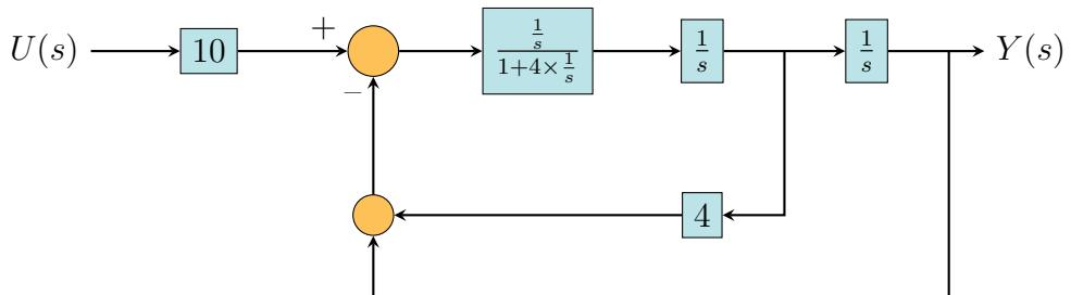
Puis, en appliquant la règle de mise en série des blocs, on obtient la fonction de transfert intermédiaire suivante :
